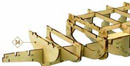
4. Извлеките деталь 34 из фанерной заготовки. Это 19-й шпангоут. Установите и приклейте его в следующее отверстие в килевой балке, как показано на рисунке. Удостоверьтесь с помощью угольника, что он установлен под углом 90°. На этом работу с корпусом корабля на сегодня мы закончим.
