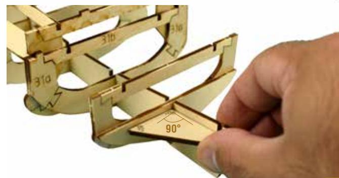
3. Извлеките деталь 33 из фанерной заготовки. Это 18-й шпангоут. 17-й и 18-й шпангоуты необходимо склеить вместе и установить в отведенное для них отверстие в килевой балке, как показано на рисунке. Удостоверьтесь с помощью угольника, что они установлены под углом 90°.
