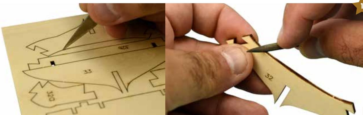
1. В этом выпуске мы продолжим сборку каркаса корпуса. Используйте цанговый нож для извлечения деталей из фанерной заготовки и мелкозернистую нахадную бумагу или напильник для удаления шероховатостей в местах соединения деталей.
